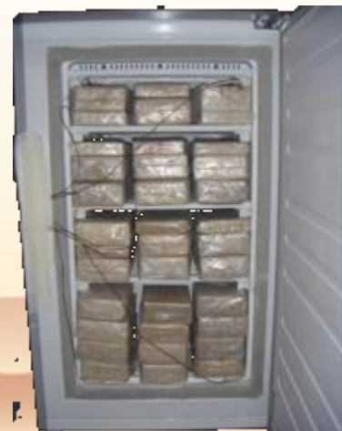
图：耗电量测试，模拟用户冷冻室放负载包图
