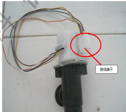
上图结构：白色线体端为公共电源端，其他四个颜色线体为相序端。
