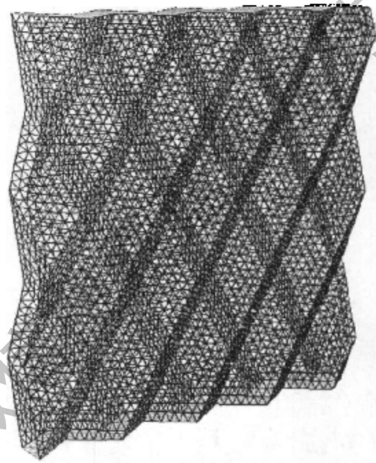
图 3.2 板片通道内部的网格划分
