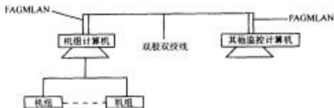
图 2-93 其他计算机与机组计算机的通信方式图
