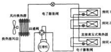
图 4-48 VRV 系统的基本原理图
