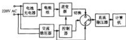
图 5-50 不间断电源原理图
