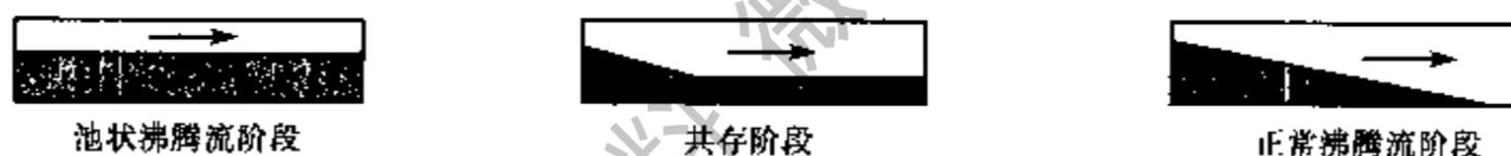
图 5-1 低压侧开机后制冷剂侧状态演变过程
