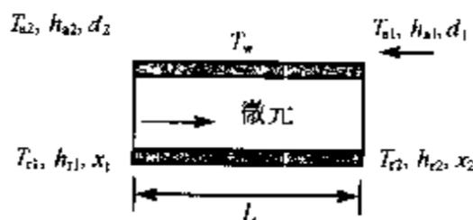
图 5-6 蒸发器微元示意图
