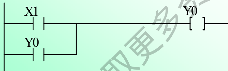
电机初步正转控制电路
