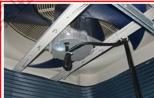
每20S将系统压力与最佳 压力值作比较，及时调 整直流风机转速
