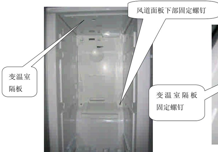
拆下左冷冻室风道面板下部的两个固定螺钉
