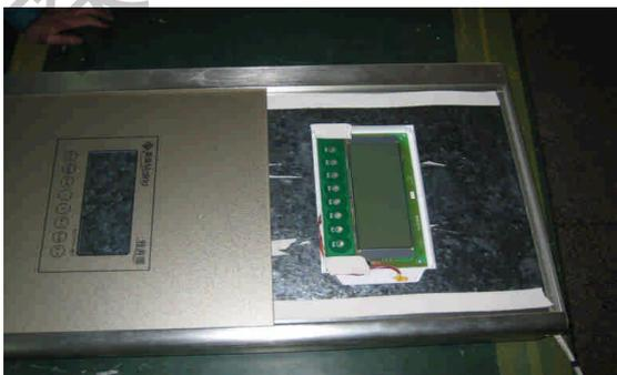
拆下玻璃后的显示板
