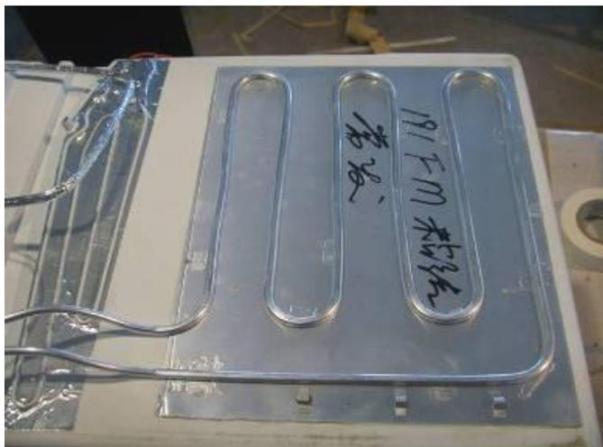
采用板管式蒸发器，辅以压合工艺，可有效提高蒸发铝板与箱胆的贴敷可靠性，避免发泡后脱粘，提高换热效率和温度均匀性，同时还简化工艺，减少操作工序和人员配置。
