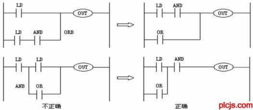
有串联电路并联时，应将接点最多的那个串联回路放在梯形图最上面。有并联电路相串联时，应将接点最多的并联回路放在梯形图的最左边。
