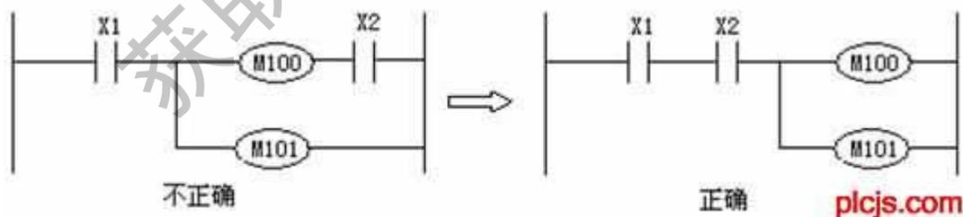
不能将接点画在线圈右边，只能在接点的右边接线圈
