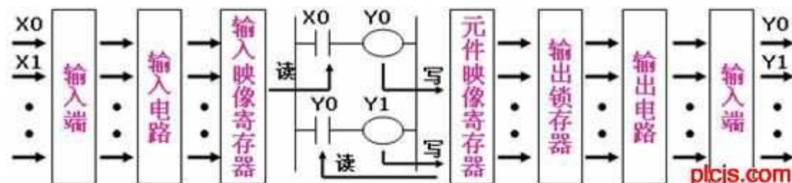
最终输出刷新：将输出映像寄存器的状态写入输出锁存电路，再经输出电路传递输出端子，从而控制外接器件动作。
