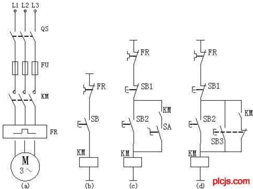
图 (a) 为主电路。工作时，合上刀开关 QS，三相交流电经过 QS，熔断器 FU，接触器 KM 主触点，热继电器 FR 至三相交流电动机。
