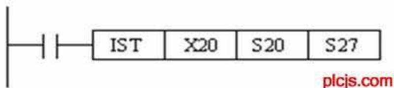
IST 中的源操作数可取 X、Y 和 M，图中 IST 指令的源操作数 X20 用来指定与工作方式有关的输入继电器的首元件，它实际上指定从 X20 开始的 8 个输入继电器，这 8 个输入继电器的意义如下表。
