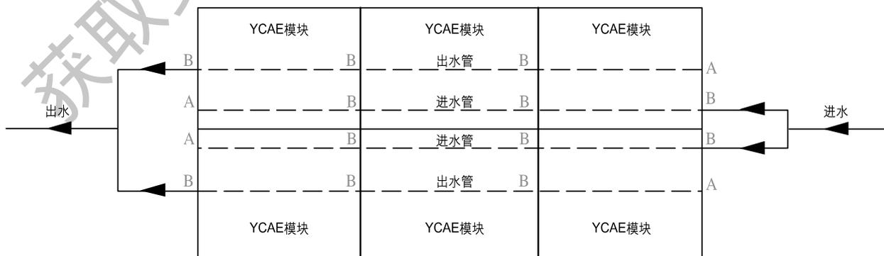
注：字母 B 表示用卡箍连接两侧的水管，字母 A 表示用封板将水管封死
