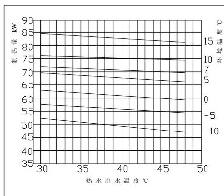
LSQW(R)F65M/B(N)制热量修正线图
