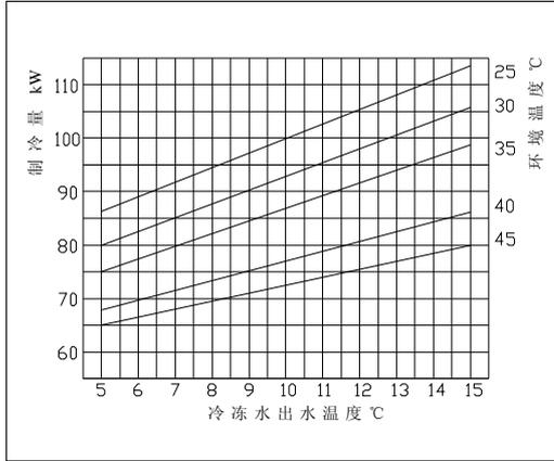
LSQW(R)F80M/B(N)制冷量修正线图
