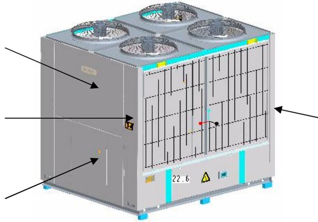
c) 拆除冷凝器外面的金属风栅；
