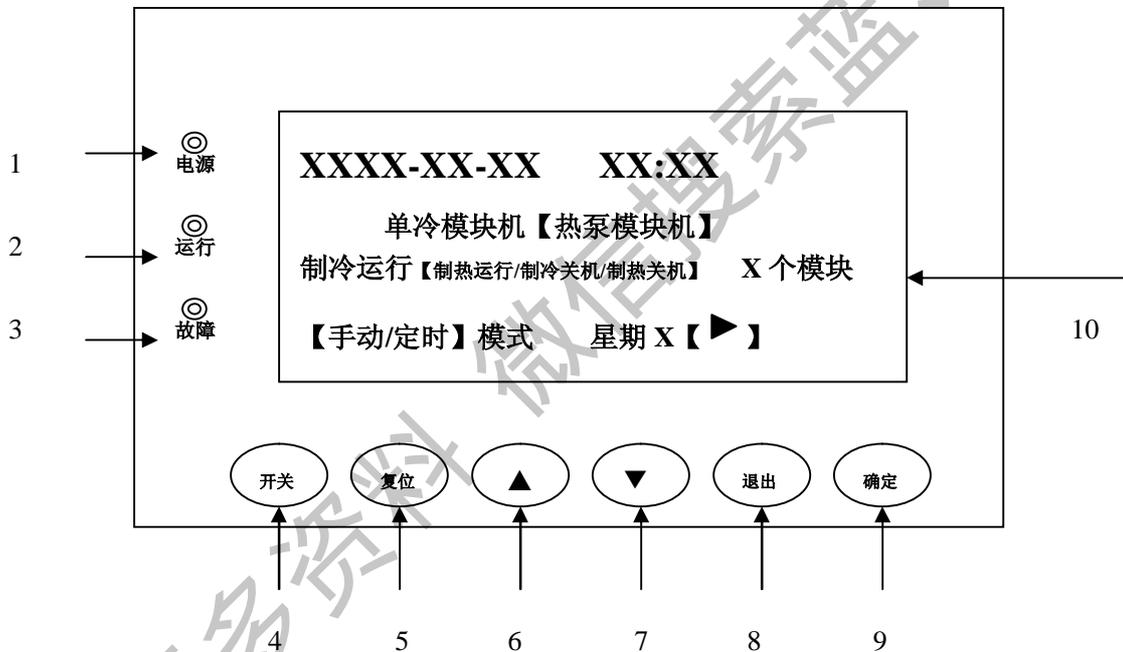
1. 电源指示灯（绿色），显示板电源接通时该指示灯亮；否则时灭。
