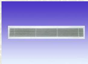
**线型散流器** 具有通风性能良好，常用于室内线型和大堂环形装饰的送、回风装置，一般最大长度3.5米，对于更大的长度则可分段对接，线性散流器有固定和活动两种，拆卸清洗方便，线型散流器可装在侧墙、天花、地板上作送、回风用。线型散流器外框有19、25、32三种规格，叶片有直叶、T形叶片、30度叶片等三种款式，30度叶片又可分单向送风和双向送风两种。线型风口还根据需要加工成弧形风口。
