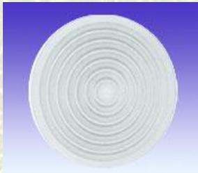
圆形散流器采用铝板一次冲压成型，中间无接缝，内蕊组件可与外框分离，拆装方便。圆形散流器整体造型美观，重量轻，具有良好的散流特性，广泛用于宾馆、商场、在型写字楼等高档场所。
