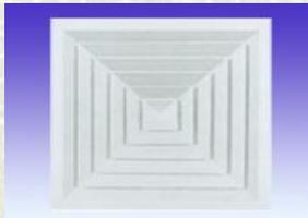
**方形散流器，矩形散流器** 具有良好的散流效果和美观的外形，它有四种不同方向送风形式供选择，可满足不同的送风要求。方形散流器外框与内蕊是组合式结构，拆装简便快捷，散流其广泛用于空调系统中作送风口用，是空调工程中应用最广泛的风口之一。
