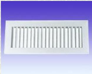
单层可调百叶风口可根据需要调节叶片左右角度，以控制冷气流出的方向，通常在空调和通风系统中作侧面送风。当作送风口用时，亦可在后面配人字调节阀调节风量。另外，单层可调百叶也可作回风口使用。单层可调百叶风口的叶片有两种款式供客户选择，一种是梗叶叶片，一种是流线型叶片。
