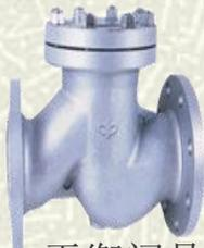
5、平衡阀：平衡阀是一种具有特殊功能的阀门，具有良好的流量特性，能够合理分配流量，实现流量定量，可以有效地解决供热（空调）系统中存在的室温冷热不匀问题。由于该阀上设有开启度指示，开度锁定装置及用于流量测定的测压小阀，所以只要在各支路及用户入口装上适当规格的平衡阀，并用专用智能仪表进行一次性调试后锁定，将系统的总水量控制在合理范围内，从而克服了“大流量、小温差”的不合理现象，但由于价格较贵，一般用于末端装置很多的大型系统和精度要求较高的情况。
