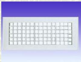
双层可调百叶风口可根据需要调解叶片上下、左右角度，以控制冷气流出的方向，从而得到不同的送风距离，还可直接与风机盘管或人字阀配套使用，通常双层可调百叶用于空调通风系统中作侧面送风口，是空调工程中应用最广泛的风口之一。双层可调百叶风口的叶片有两种款式供客户选择，一种是梗叶叶片，一种是流线型叶片
