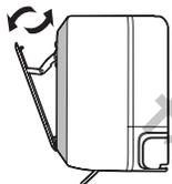
• 机器运转开始时，可动面板自动打开至如图所示位置，机器停止运转后，可动面板自动关闭。
