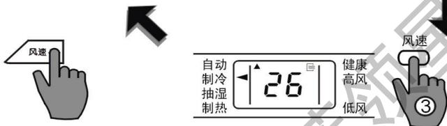
■以下展现的是风速设定确认后初始状态的风速显示，静态显示两秒后，则按1、12、123的方式按不同的频率循环显示。
