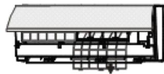
3. 用吸尘器或水冲洗空气过滤网，将其在阴凉处晾干，将空气过滤网的上部插入机内直至完全固定后，合上室内机面板。
