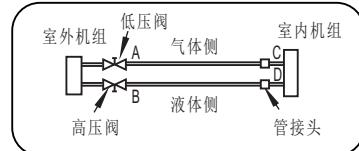
◎方法二：用制冷剂罐排除空气
