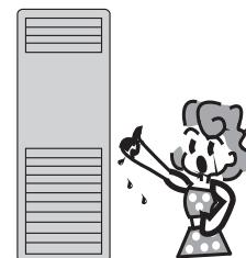
正常运行过程中，不要通过强行拔掉电源插头来停止运转，否则易引起触电及火灾，长期不使用空调器，请拔下插头或切断电源开关。
