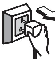
电源线不要打结、拉伸、加压重物、高温加热，否则会引起电源线破损。使用破损的电源线，可能导致触电和火灾。
