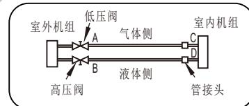
◎方法二：用制冷剂罐排除空气
