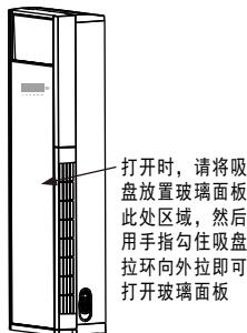
打开时，请将吸盘放置玻璃面板
