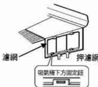
3. 把濾網朝上推, 讓濾網成弓字形狀, 使其從吸氣柵的固定鈕卸下, 然後再向前拉, 即可取下濾網。
