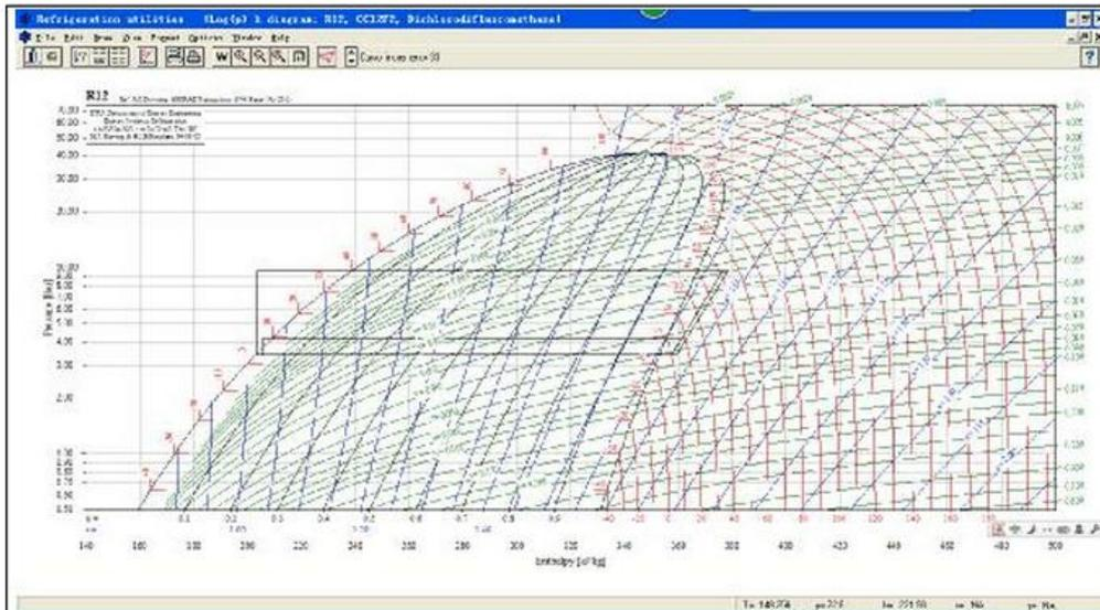
$h_4 = h_5 = 235.12 \text{ kJ/kg}$  此处的焓值按  $h_4'$  的算，即过冷度 36 度时，压力为 0.96MPa 下的焓值
