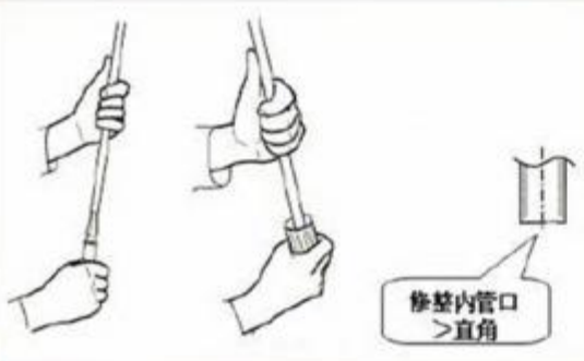
3. 管口向下用铰刀修整内管口
