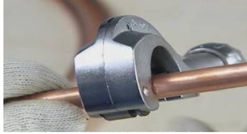
使用的专用的工具切割铜管（正确）
