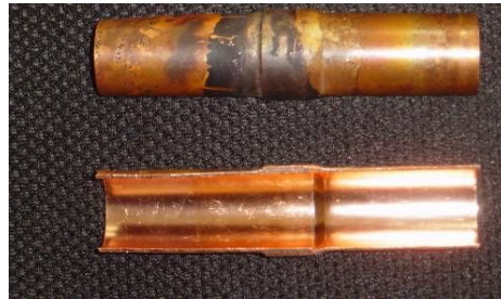
充氮焊接，铜管内壁没有氧化皮（好）
